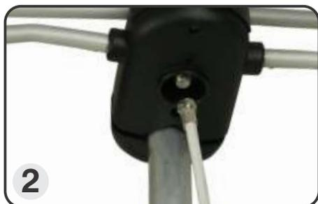
**2)** Ligue o cabo coaxial no conector F na parte inferior da antena. Conecte a outra ponta do cabo na TV.
